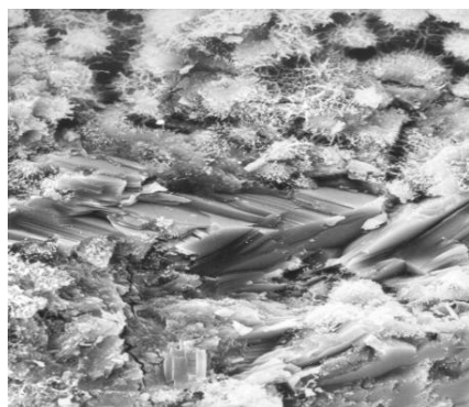
Рис. 1. Микрофотографии мономинерального цементного камня, твердевшего в среде CO 2 в течение 90 сут (x6000): а – C 3 S; б – CA
