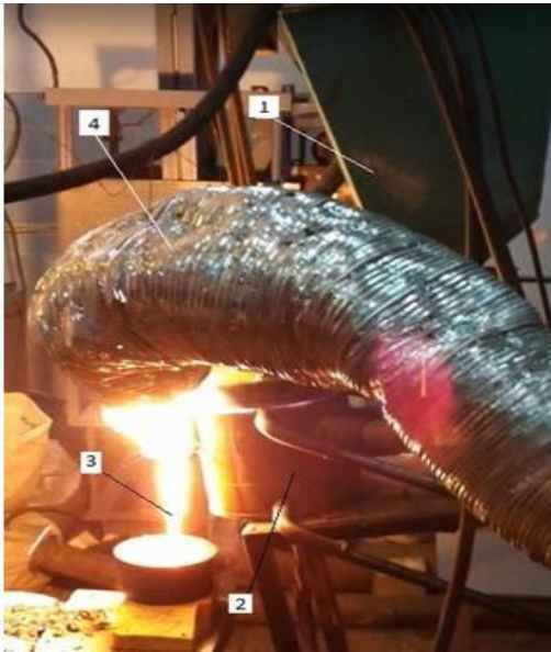
Рис. 2. Электроплазменная установка для получения высокотемпературного силикатного расплава в процессе работы: 1 – загрузочный бункер; 2 – плавильная печь; 3 – силикатный расплав; 4 – система вытяжки
