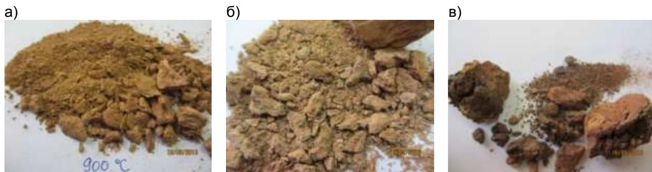
Рис. 7. Внешний вид угольных шламов, обожженных при температуре:
