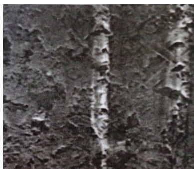
Рис. 11. Электронно-микроскопические снимки системы \text{MgO-H}_3\text{BO}_3\text{-H}_2\text{O} после обработки лазерным излучением
