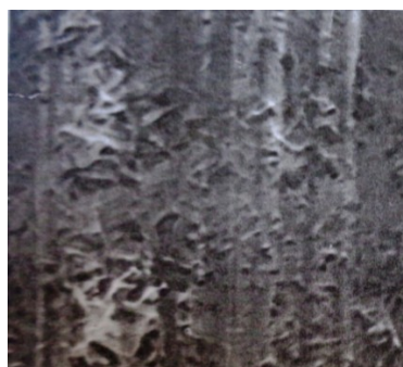
Рис. 11. Электронно-микроскопические снимки системы \text{MgO-H}_3\text{BO}_3\text{-H}_2\text{O} после обработки лазерным излучением
