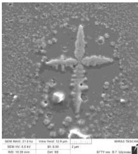
Рис. 4. Электронная микрофотография термообработанного (520 °С, 2 ч) стекла № 11
