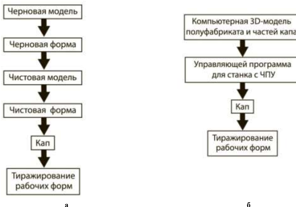
Рисунок 1 – Схемы изготовления технологической оснастки традиционным способом (а) и способом быстрого прототипирования (б)
