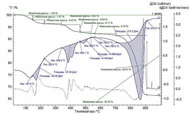
Обжиг образцов МПСП (после предварительной сушки) производился в муфельной печи при температуре 950°С (необходимая температура обжига была определена по результатам термического анализа). Для обжига была принята усредненная проба МПСП, высушенная до постоянной массы. Фотография МПСП после обжига представлена на рисунке 1в. Результаты рентгенофазового анализа МПСП после обжига представлены в таблице 2.
