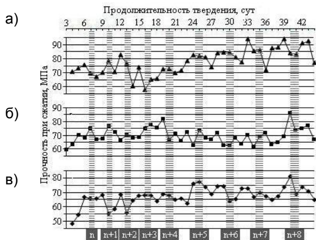
Рис. 2. Кинетика прочности образцов на новороссийском с В/Ц = 0,28 (а), верхнебаканском с В/Ц = 0,26 (б) и верхнебаканском с В/Ц = 0,30 (в) портландцементях
