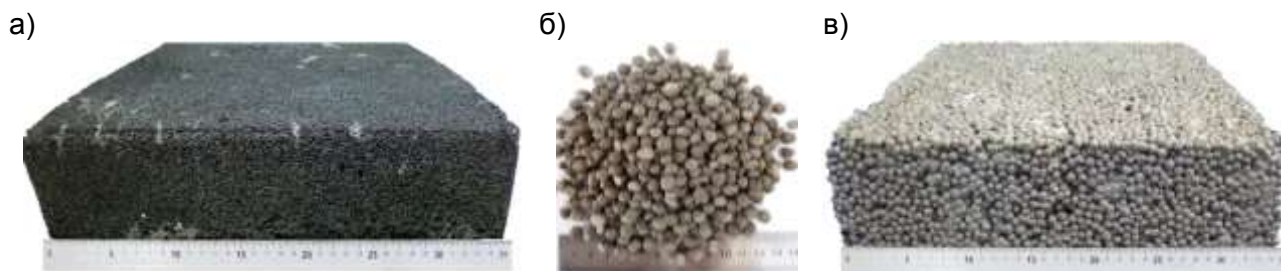
Рис. 2. Фотографии полученных образцов строительной продукции: а – плита из ячеистого стекла; б – гравий; в – легкий бетон
