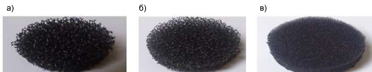
Рис. 1. Пенополиуритановые (ППУ) матрицы с диаметром ячейки: а – 5 мм; б – 1 мм; в – 0,5 мм
