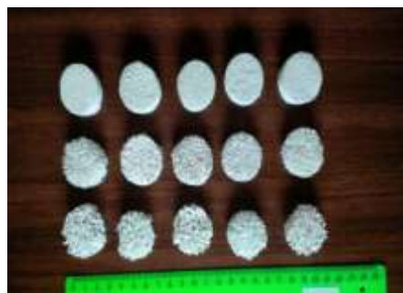
Рис. 3. Внешний вид высокопористых ячеистых носителей катализаторов после обжига
