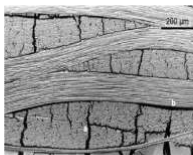
Рис. 3. Сканирующее электронное изображение на основе композита для силицирования: а – сегментационные трещины; б – микрорасслоения
