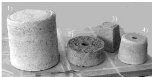
Рис. 1. Изделия, выполненные методом набивки: 1) цилиндр; 2) конус диаметром 135 мм с отверстием; 3) усеченная пирамида; 4) усеченный конус с отверстием
