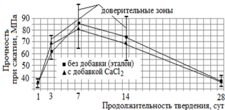
Рисунок 4 – Кинетика прочности эталонного и с хлоридом кальция (1 %) цементного камня с исходным В/Ц=0,30 (египетский ПЦБ I-500-Д0)
