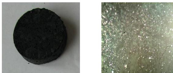
Рисунок 1 – Внешний вид продукта спекания и морфология поверхности  $\text{NiCr}_2\text{O}_4$  при 900 °С.
