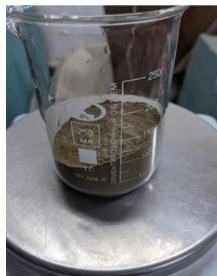
Для корректирования сроков схватывания и плотности смеси выбран поликарбоксилатный пластификатор PC-1021 Еврохим. Содержание пластификатора в составе смеси было постоянным и составляло 1 %.
